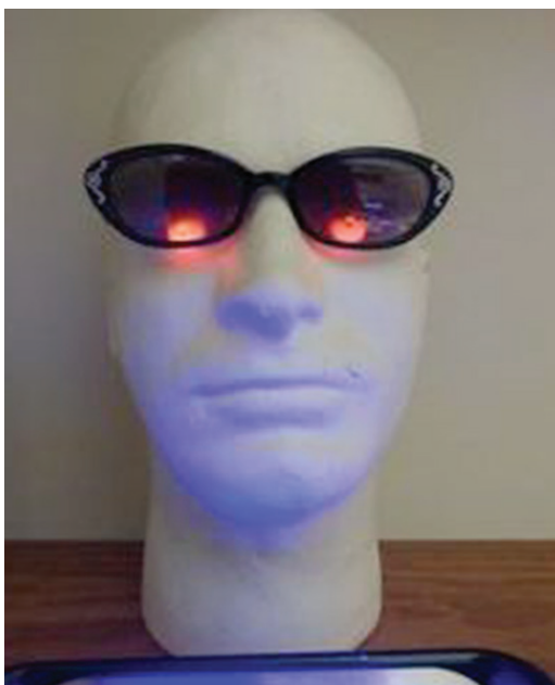
Ilustracja 2. Po lewej: fluorescencja farby czułej na promienie UV, umieszczonej w miejscu oczu, wskazuje na znaczne oddziaływanie promieniowania UV, nawet pomimo noszenia okularów przeciwsłonecznych. Po prawej: Okulary przeciwsłoneczne o dużej krzywiznie oprawy, dopasowane do kształtu twarzy, zapewniają większy stopień ochrony przed promieniowaniem UV.
