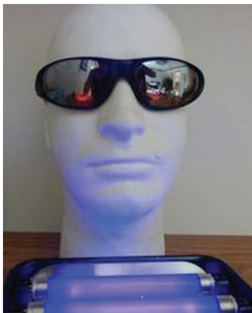
Ilustracja 2. Po lewej: fluorescencja farby czułej na promienie UV, umieszczonej w miejscu oczu, wskazuje na znaczne oddziaływanie promieniowania UV, nawet pomimo noszenia okularów przeciwsłonecznych. Po prawej: Okulary przeciwsłoneczne o dużej krzywiznie oprawy, dopasowane do kształtu twarzy, zapewniają większy stopień ochrony przed promieniowaniem UV.
